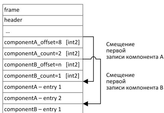
Рисунок 10. Схема сообщения с двумя повторяющимися компонентами
